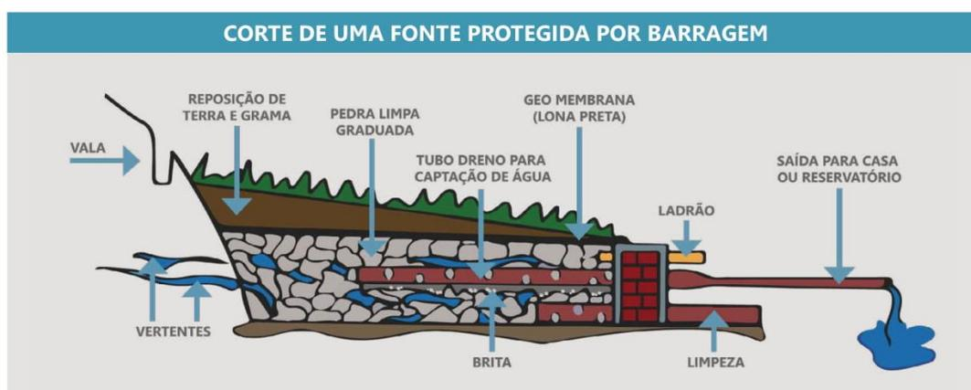
**Figura 71** - Modelo de proteção de fonte drenada de encosta (ex.: fonte drenada L. Nova Brasília)<sup>10</sup>
