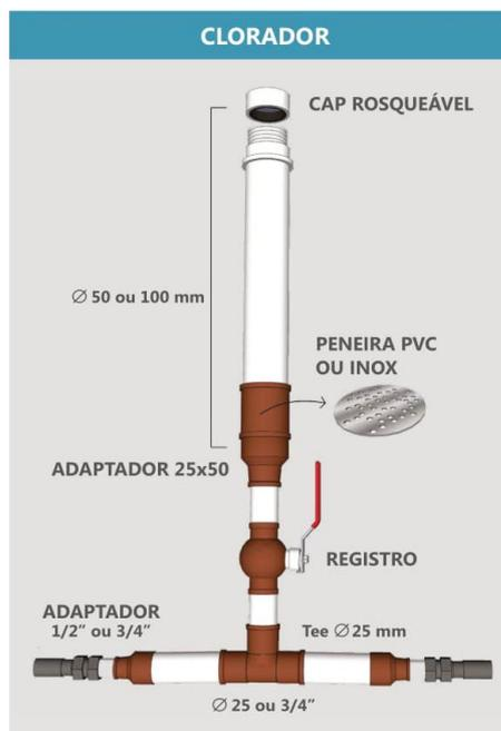
**Figura 73** - Modelo de manutenção de fontes de água<sup>12</sup>
