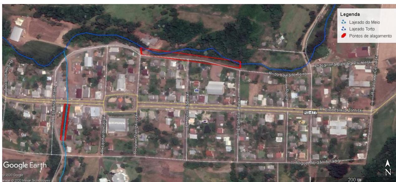
**Figura 100** - Pontos críticos de alagamento em área urbana, salientado em vermelho no croqui. Na linha azul é demonstrado os recursos hídricos existentes.
